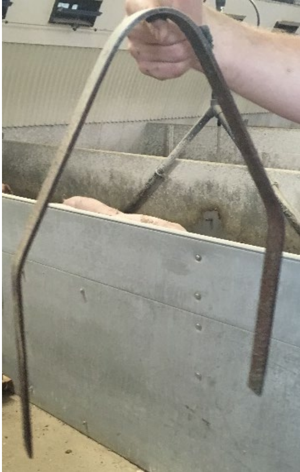
Figur 5. Simple udgave af "Olsen vægt", hvor bredden justeres løbende.
